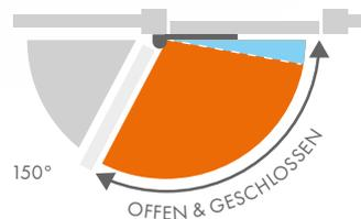
Max. 150°, abhängig von der Position des Scharniers und des Torschließers
