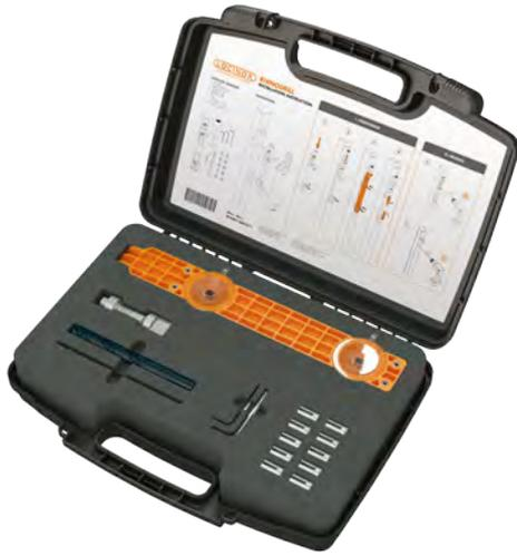
Werkzeugkoffer mit Montageset zum Bohren der Löcher bei der Installation des Rhino-Torschließers auf den Locinox-Bändern. Der Rhino nutzt das Band um das Tor zu schließen. Dieses Tool gewährleistet eine perfekte Ausrichtung des Rhino-Torschließers am vorhandenen Torband. Ausmessen ist unnötig: Tool befestigen, bohren, Rhino einbauen und fertig!
