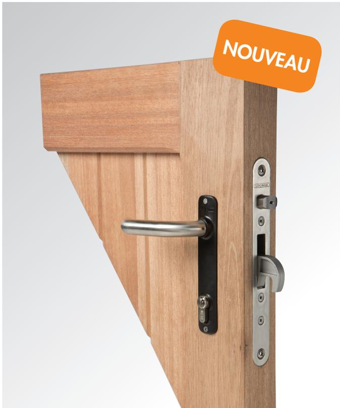
Serrure à encastrer 100% acier inoxydable spécialement conçu pour les portes battantes en bois. Pêne demi-tour réversible et réglable de 20 mm, pêne dormant en forme de crochet basculant afin d'éviter l'écartement des vantaux. La combinaison des deux pènes assure un verrouillage sûr et sécuritaire.
