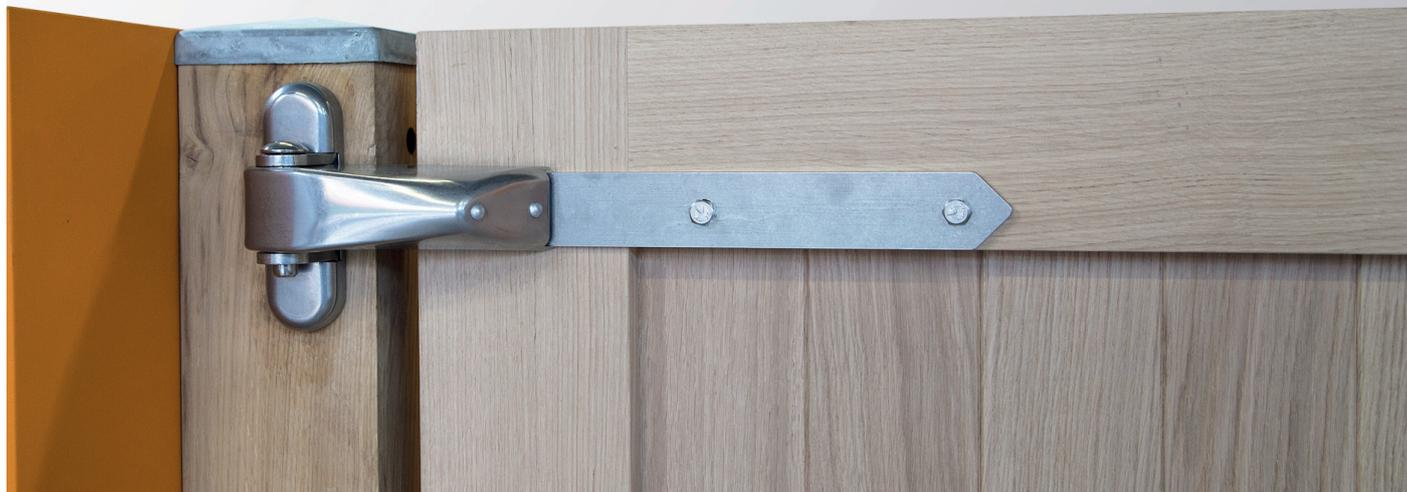
Charnière anti-dégondage esthétique pour portes en bois. La charnière en acier inoxydable est réglable sur 4 dimensions. Hauteur, profondeur, largeur et sens de rotation. Les réglages sont toujours possible sans démontage de la charnière. Votre porte est toujours parfaitement alignée, même si elle se déforme à cause des conditions météorologiques ou en fonction du temps.
